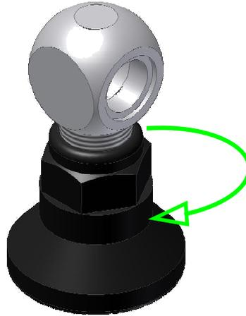
2. Trichter mit Einzelteilen entnehmen und verschlissene Teile gegen Neue austauschen.
